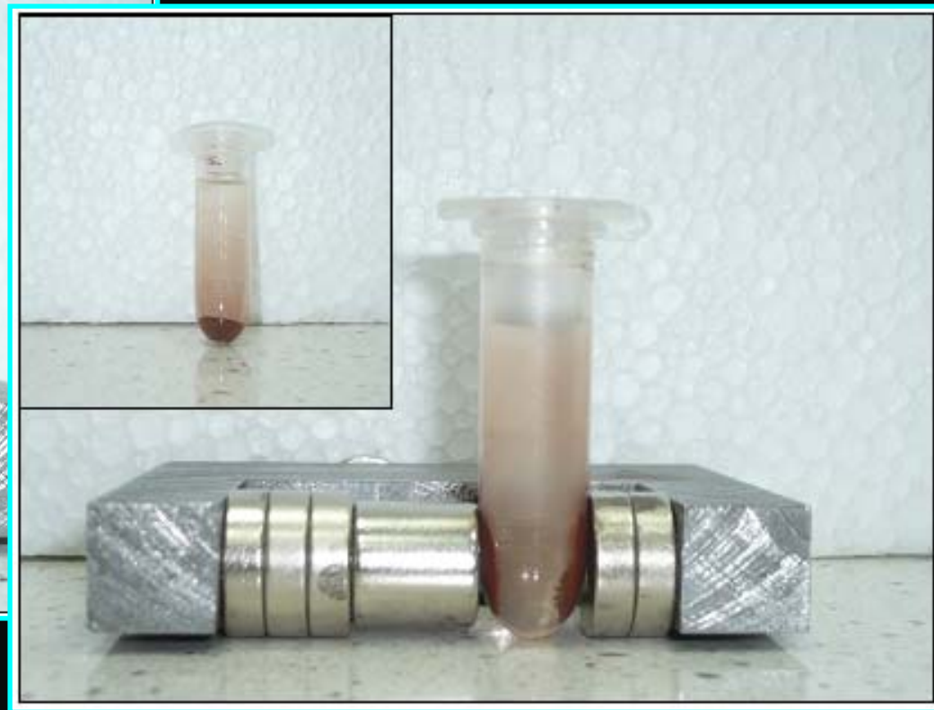
Nanocząstki \text{Fe}_2\text{O}_3 po wygrzaniu ( 2R = 37,5 \text{ nm} )
