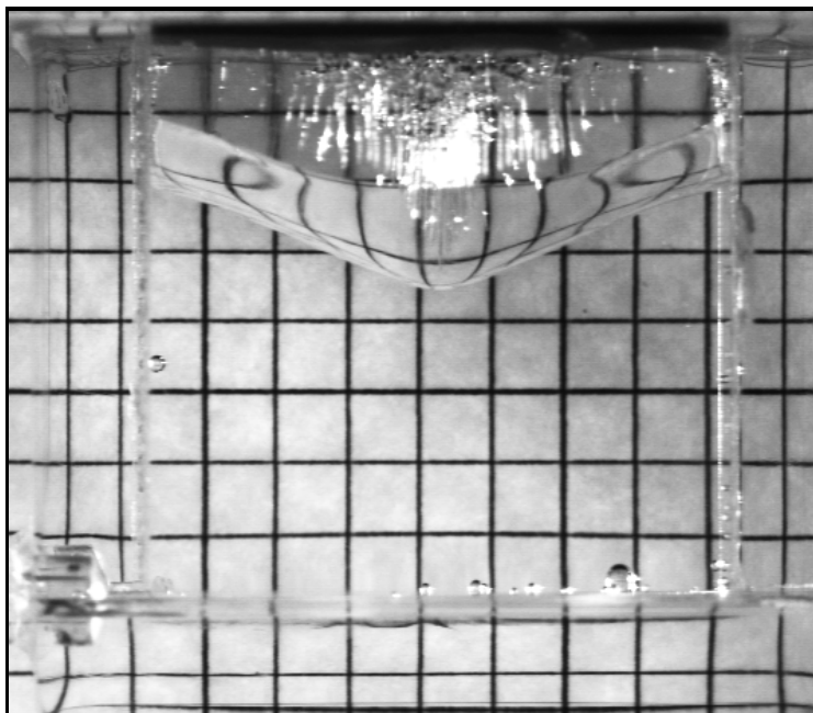
Rys. 13. Struktura lodu tworzącego się w kanale z pleksiglasu na tle 5mm kraty; T_h=20^{\circ}\text{C} , T_c=-10^{\circ}\text{C} .
