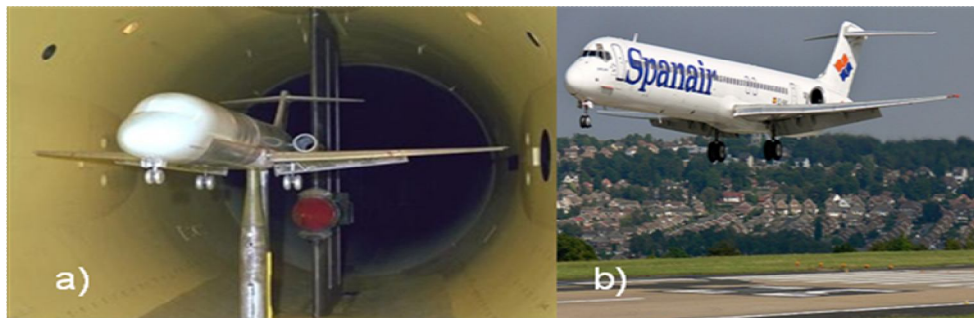
Rys. 4. Model samolotu badany w tunelu aerodynamicznym a) i zaprojektowany z użyciem badań modelowych samolot MD 80 b) [8, 9]
