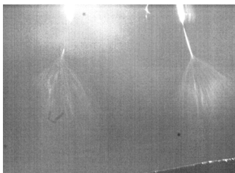
Rys. 8-2 Elektroprzędzenie z układu dwóch dysz dla odległości pomiędzy dyszami 10 mm, odległość od targetu 15 cm, potencjał 18 kV.
