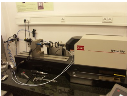
Rys. 7-7 Maszyna wytrzymałościowa MTS Tytron 250.
