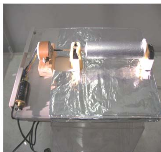
Rys. 9-3 Układ do elektroprzędzenia z targetem w postaci obracającego się walca.
