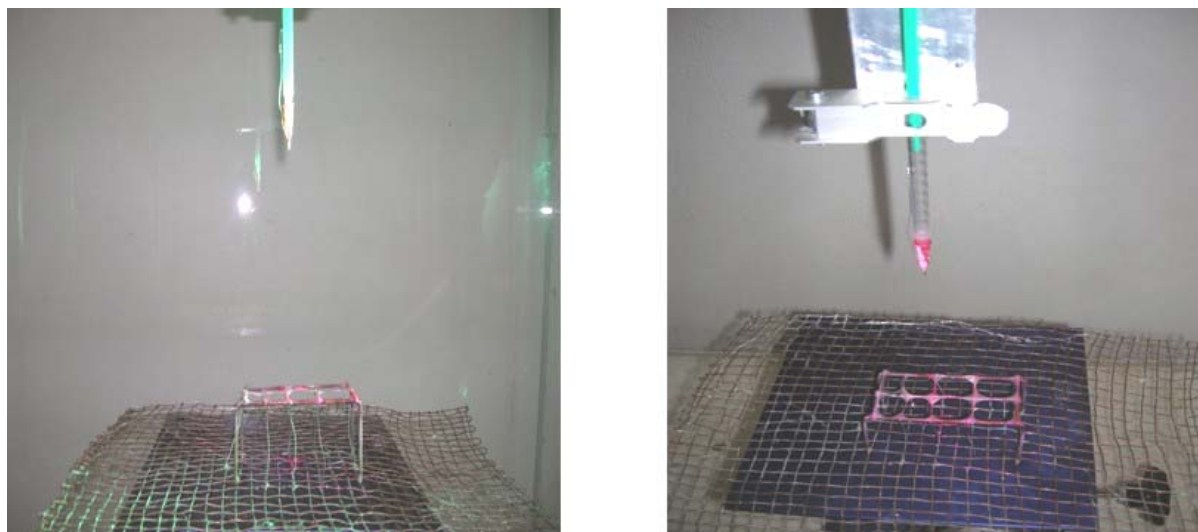
Rys. 9-1 Standardowy układ do odbioru elektroprzędzonych włókien.
