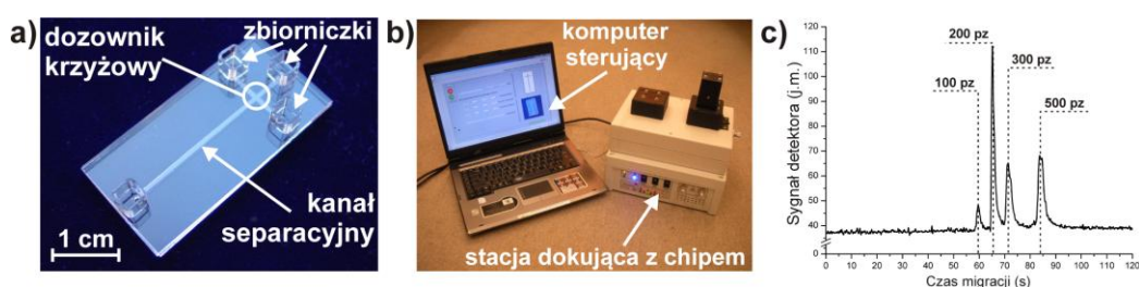
Rys. 1. Instrument lab-on-a-chip do analizy materiału genetycznego: a) szklany chip do elektroforezy, b) widok gotowego instrumentu, c) wyniki separacji fragmentów DNA o długości 100-500 par zasad (pz).
