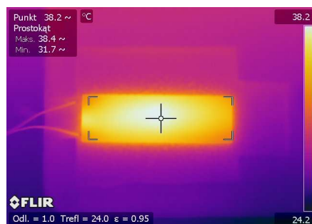
Rys. 2. Rozkład temperatury w prezentowanej grzałce.
