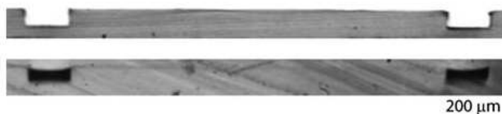
Rys.1. Mikrograficzny obraz przekrojów poprzecznych kanałów o szerokości 200 \mu m przed (górną) i po łączeniu termicznym dwóch płyt PC (dolną). Prezentowany obraz pokazuje istotną termiczną deformację mikrokanalów.
