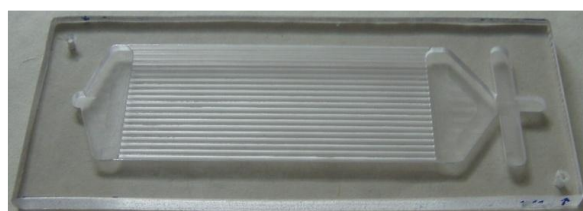
Rys. 2.4. Wstępny model eksperymentalny kanału z pofalowanymi ściankami wykonany z poliwęglanu, składający się z 20 segmentów pofalowania; ścianka górna jest płaska, aby zapewnić niezakłócony dostęp optyczny do wnętrza kanału.
