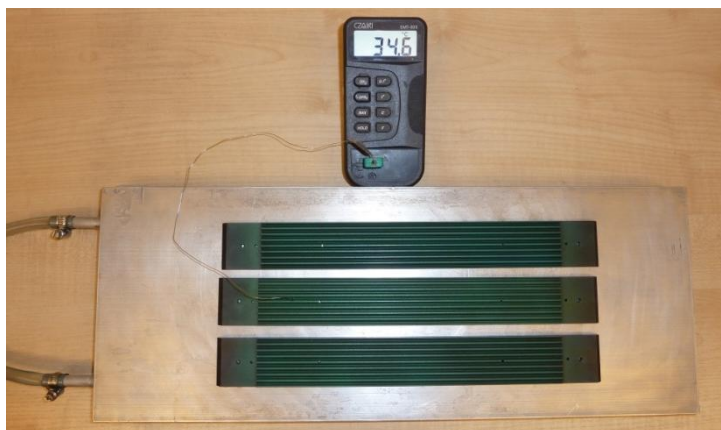
Rys. 6. Płytki w trakcie testu odporności pokrycia ciekłokrystalicznego na działanie lakieru.
