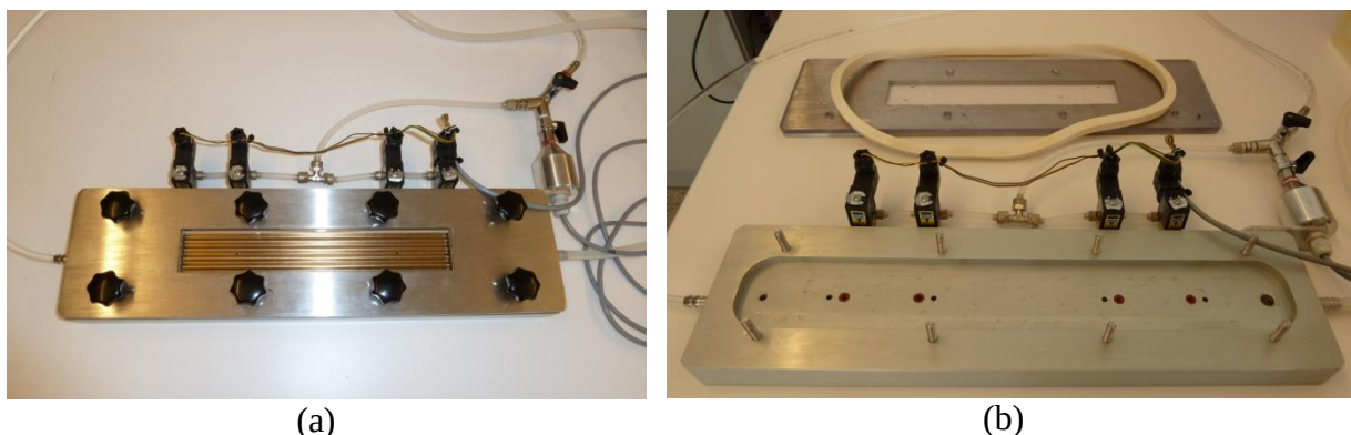
Rys. 1. Model eksperymentalny kanału; a) widok kompletnego kanału z zamontowaną wkładką G_3 oraz widocznym układem pomiaru ciśnienia; b) kanał ze zdemontowaną górną ścianką – widoczna przestrzeń montowania wkładek zapewniających odpowiednie pofalowanie dolnej ścianki kanału.
