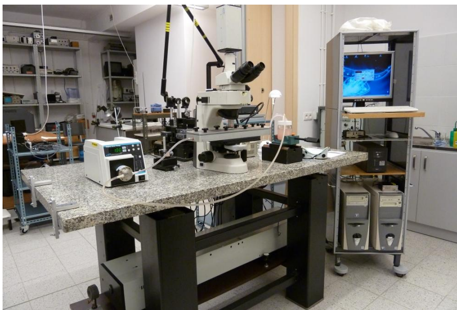
Rys. 10. Stanowisko pomiarowe techniką \mu\text{PIV} z widocznymi głównymi elementami: mikroskop epi-fluorescencyjny z zamontowaną kamerą CCD oraz umieszczonym na jego stoliku kanałem pomiarowym, pompa zębata, ramię optyczne i układ optyczny formujący i doprowadzający wiązkę lasera do wnętrza mikroskopu oraz komputer sterujący pracą całego układu.
