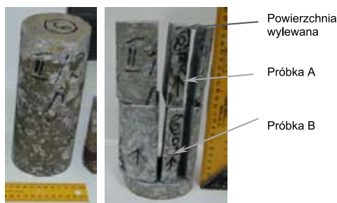
Ryc. 1 Zdjęcie przykładowego odwiertu pobranego z nawierzchni: a) po dostarczeniu do laboratorium, b) po przecięciu
