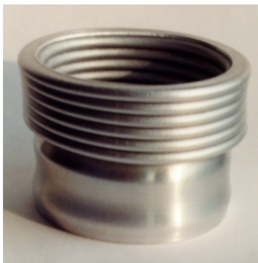
Rys. 2.26: Wynik eksperymentu dynamicznego zgniatania cylindra.
