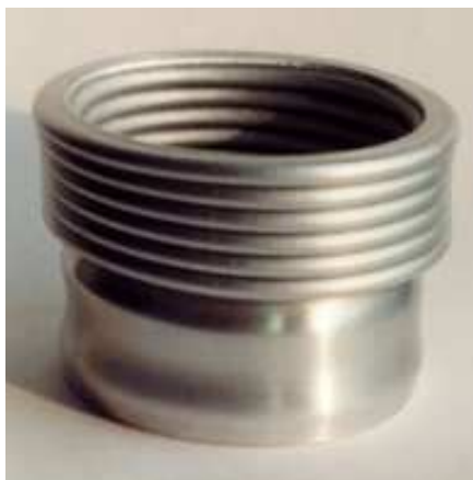
Rysunek 4.38: Wynik eksperymentu dynamicznego zgniatania cylindra.
