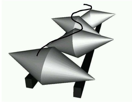
Rysunek 8.13: Wężykowanie przy różnej prędkości liniowej toczenia.
